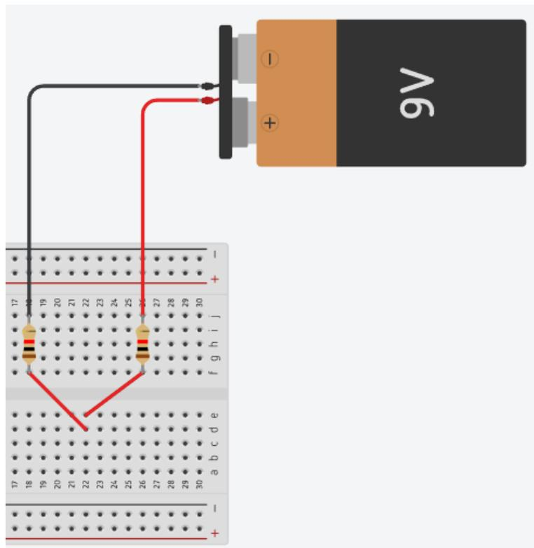
Il nous suffit ensuite de brancher au bout un fil vers l'ESP32 à un pin digital qui reçoit au maximum 3 volts. S'il reçoit 3 volts, il renvoie 4095. En utilisant cette information, il ne nous reste plus qu'à faire un pourcentage pour avoir le taux de batterie.
