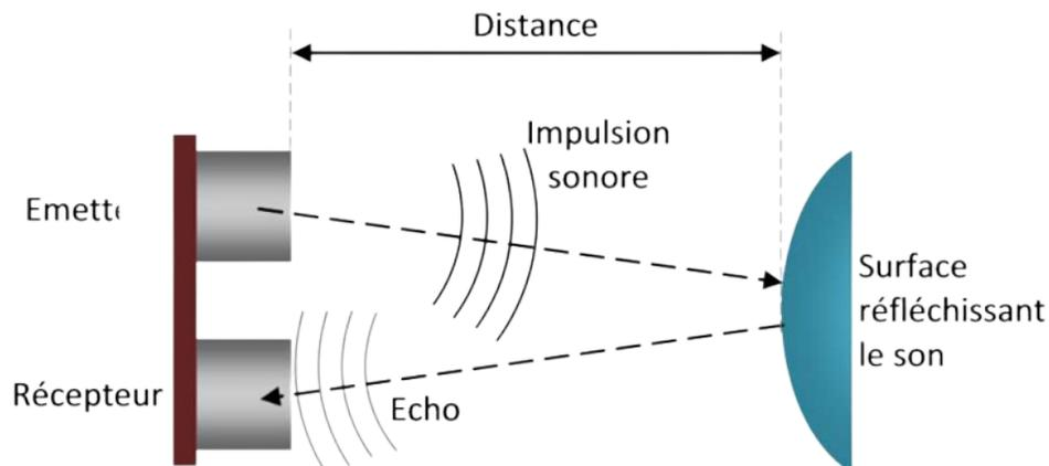
En le plaçant sur le dessus du récipient de gel, on obtient donc la distance entre le haut et la surface du gel présent dans la borne, il nous restera plus qu'à en faire le pourcentage en prenant en compte la distance maximale atteignable entre le capteur et le fond du récipient donc.
